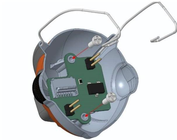
Schrauben Sie das BUZZER-Modul (mit seinem Band) in den Kopf in genau der oben gezeigten Position.
