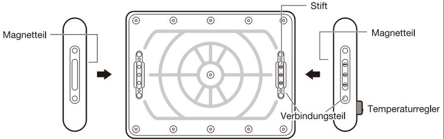
Die Magnetteile der beiden Ständer nach innen richten und in die Verbindungsteile der Platte einstecken. Den Ständer mit dem Temperaturregler in das Verbindungsteil mit dem Stift einstecken.
