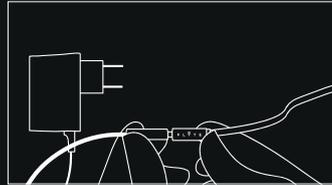
2. Schließen Sie das Netzteilkabel an das andere Ende des Silikonkabels an.
