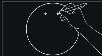
1. Verwenden Sie die Schablone in der Verpackung, um Löcher zu markieren und zu bohren.
