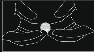
2. Senken Sie die Kugel langsam ab, beginnend etwa 10cm über der LED-Anzeige. Fühlen Sie, wie der Mittelpunkt des Magnetfelds das Gewicht der Kugel hält.
