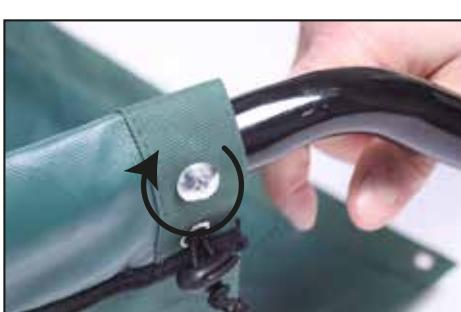
Gewebe-Plane an den Handgriffen mittels der Kreuzschlitzschrauben befestigen.
