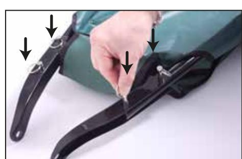
Rohre an der Radaufhängung mittels der 4 Federkugel-Stifte befestigen.
