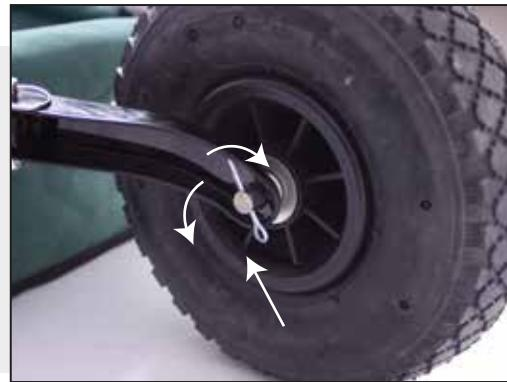
Rad an der Radaufhängung mittels Radachse und Splint in dieser Reihenfolge befestigen:
