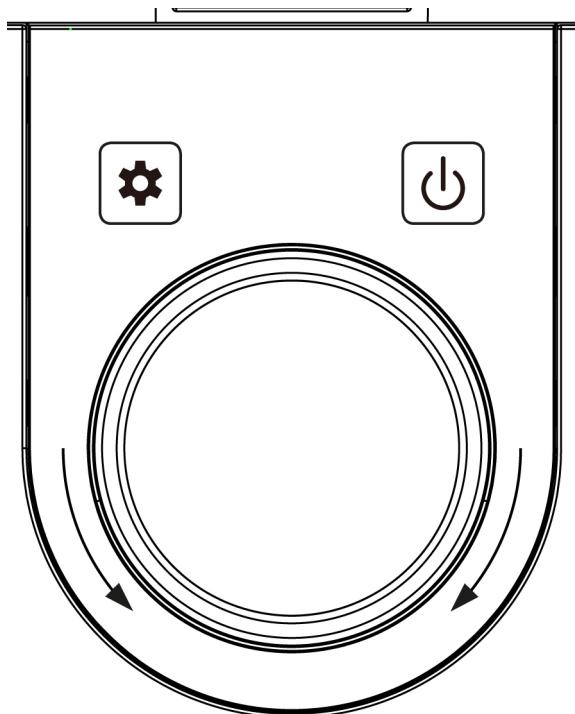
Регулятор: Установка значений часов и минут для часов и таймера
