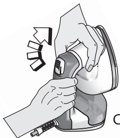
C Faire pivoter la semelle dans le sens des aiguilles d'une montre en utilisant la poignée
