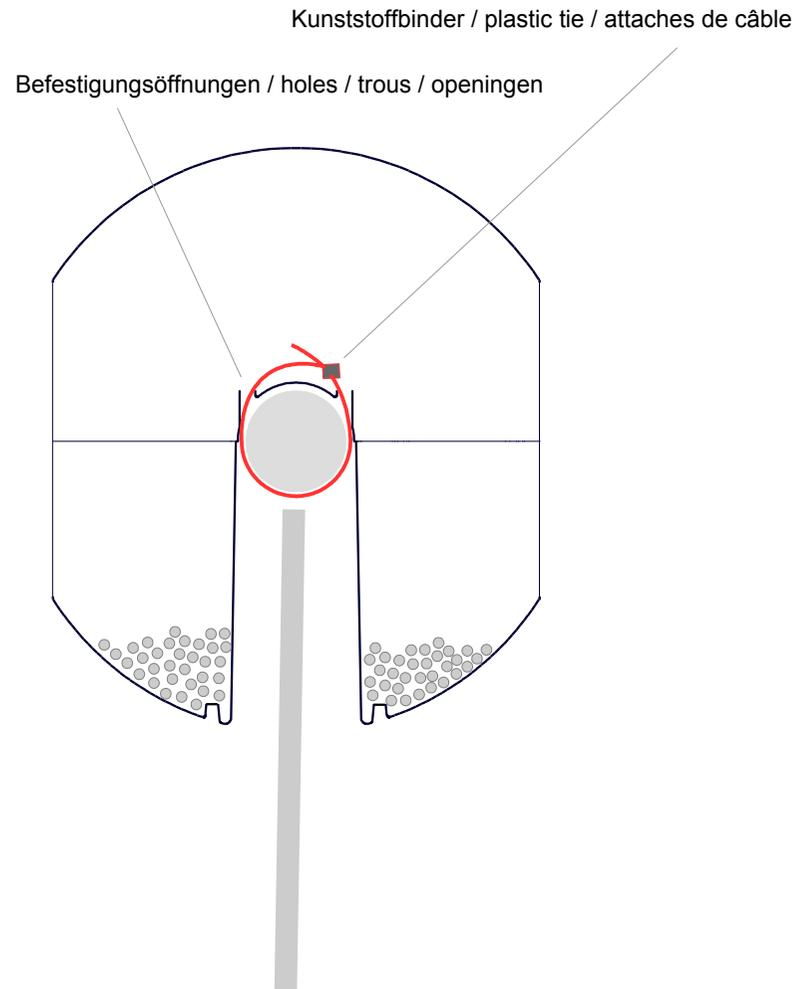
**D: birdball ist mittels des beigefügten Kunststoffbinders am Geländer zu sichern!**
