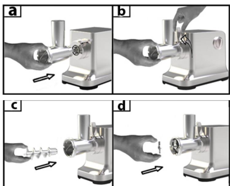
d) Coloque la cuchilla (9) en el sinfín de compresión (8).
