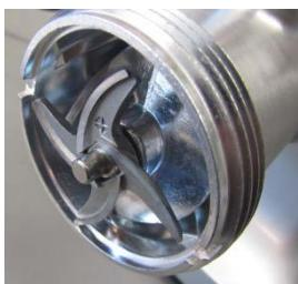
e) Coloque el disco perforado (10, 11 o 15) sobre la cuchilla (9) y el sinfín de compresión (8).
