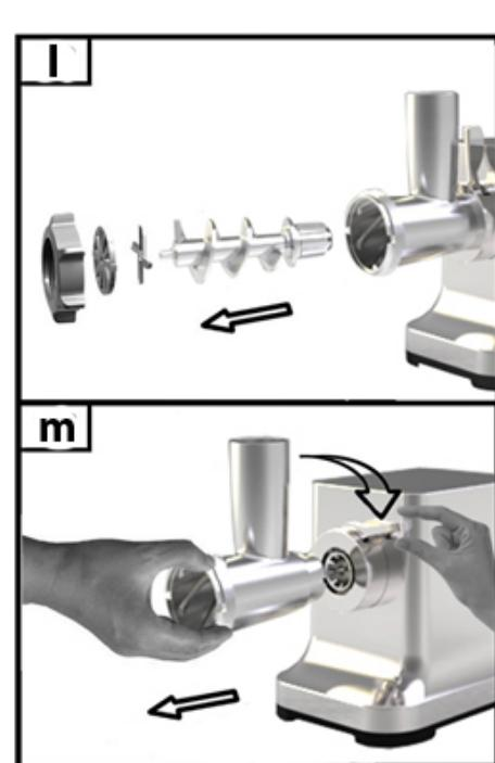
Reinigen Sie diese Bauteile direkt nach Gebrauch. Spülen Sie die Bauteile mit heißem Wasser ab und trocken Sie diese umgehend ab. Sie können Stopfer (5) , Messer (9), die Lochscheiben (10, 11, 15) , den Aufsatz zur Wurstherstellung (13) sowie den Aufsatz für Teig mit Schablone in die Spülmaschine ( 14) geben.
