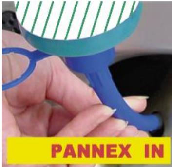
(5) Füllen Sie nun das PANNEX Dichtmittel entsprechend der Dosierungsangabe durch den offenen Ventileinlass durch Druck auf die Flasche in den Reifen.
