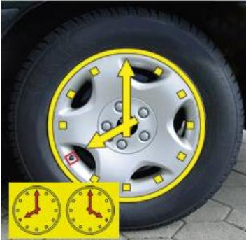
(1) Drehen Sie den defekten Reifen in die richtige Position: Ventil in „8-Uhr“- oder „12-Uhr“-Stellung!
