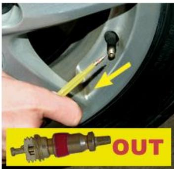
(2) Drehen Sie nun den Ventileinsatz mit dem mitgelieferten Ventil-schrauber [4] heraus und lassen Sie dadurch die restliche Luft entweichen. Den Ventileinsatz und -schrauber anschließend zum Schutz vor Wegrollen in die
