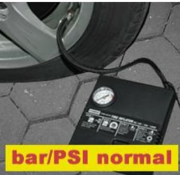
(8) Verbinden Sie den 12V-Adapter [2] mit der 12V-Zigarettenanzünder-Steckdose ihres Fahrzeuges und stecken Sie den Kompressor-Schlauch auf das Ventil.
