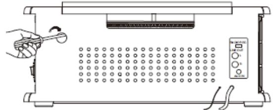
Wenn der Plattenspieler sich nicht automatisch nach dem Ende des letzten Titels abschaltet, drehen Sie vorsichtig die Schraube 45° gegen den Uhrzeigersinn. Überprüfen Sie die Einstellung mit einer Platte. Sollte der Plattenspieler erneut nicht abschalten, wiederholen Sie den o.g. Schritt, bis der Plattenspieler sich automatisch abschaltet.
